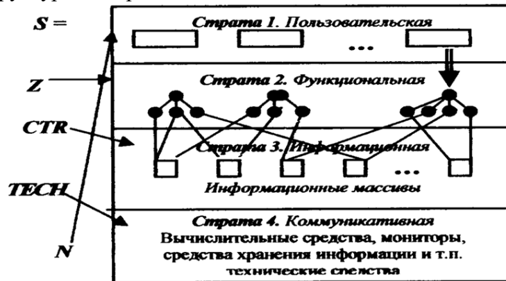
Рис. 2 Стратифицированная структура информационно-управляющего комплекса / The stratified structure of the information and control complex
